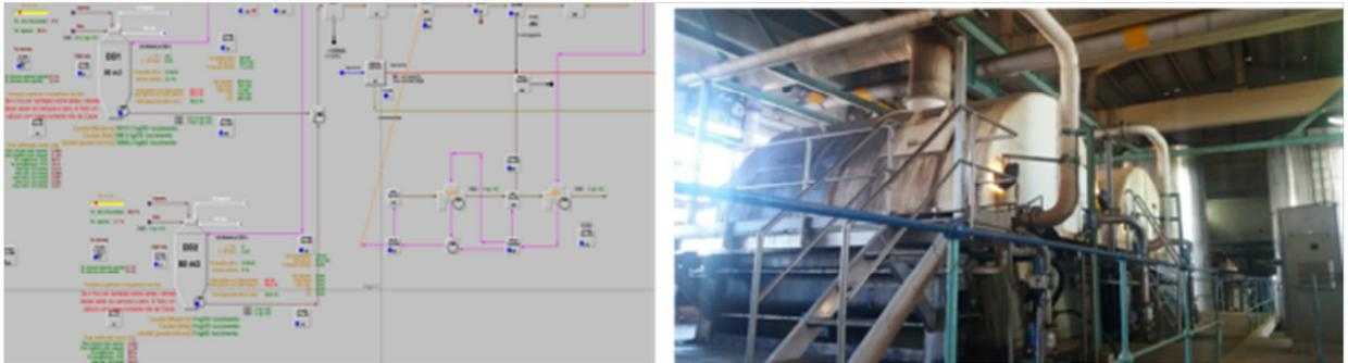
Simulação de processo utilizando software WinGems® para avaliar a reactivação de 2 lavadores.
