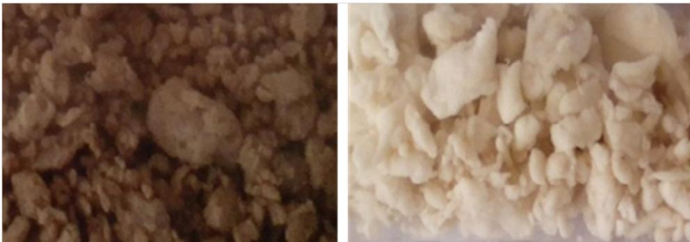
Pastas organossolv de eucalipto antes e depois da deslenhificação no RAIZ.
