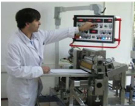
Revestidora laboratorial para deposição superficial.
